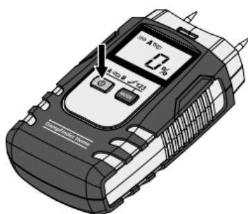
Η συσκευή απενεργοποιείται αυτόματα, μετά από 3 λεπτά για να διαφυλάσσονται οι μπαταρίες. Για να ενεργοποιήσετε στη συνέχεια πάλι τη συσκευή, πίεστε το διακόπτη On/Off.
