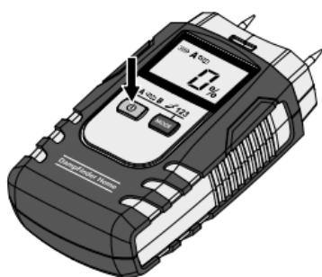
Pre ochranu batérií sa prístroj po 3 minútach automaticky vypne. Pre opäťovné zapnutie prístroja stlačte tlačidlo zap / vyp.
