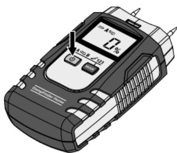
Naprava se po 3 minutah samodejno izključi zaradi varčevanja z baterijom. Če želite napravo po tem znova vključiti, ponovno pritisnite stikalo za vklop/izklop.
