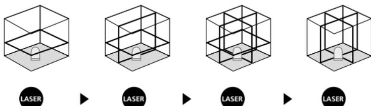
**!** Per il livellamento orizzontale e verticale si deve allentare la sicura di trasporto. Non appena l'apparecchio si trova al di fuori del campo di livellamento automatico di 3°, le linee laser iniziano a lampeggiare. Posizionare l'apparecchio in modo che si trovi all'interno del campo di livellamento.
