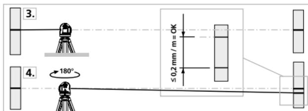
**!** Wanneer het verschil tussen punt A2 en A3 groter is dan de aangegeven tolerantie, nl. 0,2 mm / m, is een kalibratie nodig. Neem hiervoor contact op met uw vakhandelaar of met de serviceafdeling van UMAREX-LASERLINER.
