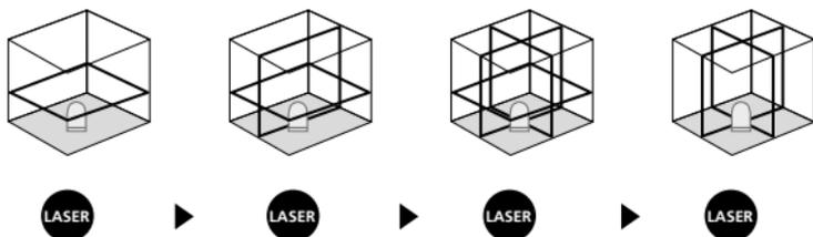
**!** Voor de horizontale en verticale nivellering moet de transportbeveiliging gedeactiveerd zijn. Zodra het apparaat zich buiten het automatische nivelleerbereik van 3° bevindt, knipperen de laserlijnen. Positioneer het apparaat zodanig dat het zich binnen het nivelleerbereik bevindt.
