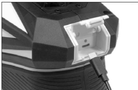
**!** De accu kan ook los van het apparaat of tijdens het bedrijf worden opgeladen. De laadstatus is alleen te zien op de accu zelf.
