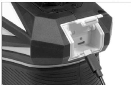
**!** La batteria può essere caricata anche fuori dall'apparecchio. Lo stato di carica è riconoscibile solo sulla batteria stessa.
