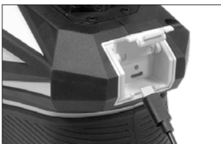
! Punjiva baterija može se puniti izvan uređaja ili tijekom pogona. LED uređaja svjetli zeleno kad je umetnuta punjiva baterija i kad se uređaj može uključiti.
