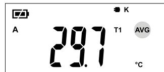
**A** Druk op toets A om de waarden MAX, MIN, AVG van sensor T1 en de verschilwaarde T2-T1 weer te geven.
