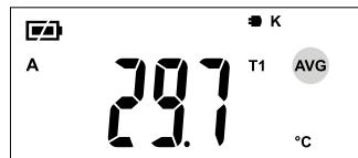
**A** Når der trykkes på tast A, vises værdierne MAX, MIN, AVG for føler T1 samt differensværdien T2-T1.
