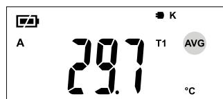
**A** После нажатия кнопки А отображаются значения MAX, MIN, AVG датчика T1, а также дифференциальное значение T2-T1.
