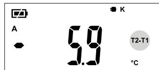
**A** A tuşuna basıldığında T1 sensörünün MAX, MIN, AVG değerleri ve T2-T1 arasındaki değer farkı gösterilir.
