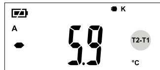
**A** Ao pressionar a tecla A são indicados os valores MAX, MIN, AVG do sensor T1, assim como o valor diferencial T2-T1.
