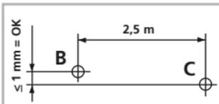
**!** Controllare regolarmente la regolazione prima dell'uso e dopo il trasporto o un lungo periodo di immagazzinamento.
