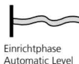
tilt Aktivieren des ADS: Tilt-Taste drücken, blinken der Tilt-LED im Sekundentakt.
