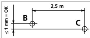
Provjeriti je li horizontalna linija od točke C poravnana s točkom B i da odstupanje nije veće od  $\pm 1$  mm. Ponoviti postupak okretanjem lasera uljevo.
