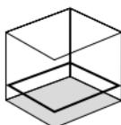
Desfaceți siguranța de transport, glisați întrerupătorul glisant (2) spre stânga. Apare linia laser.
