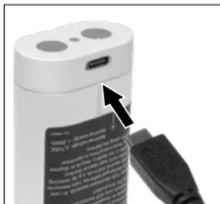
**!** Η επαναφορτιζόμενη μπαταρία επιτρέπεται **να** φορτίζεται μόνο με τον φορτιστή που συνοδεύει τη συσκευή και να χρησιμοποιείται αποκλειστικά **με αυτή τη** συσκευή λήψης. Σε διαφορετική περίπτωση υπάρχει κίνδυνος τραυματισμού και πυρκαγιάς.
