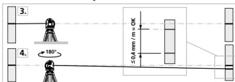
3. Ustaw najbliżej jak to możliwe ściany na wysokości punktu zaznaczonego A1.
