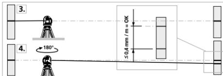
3. Stellen Sie das Gerät so nah wie möglich an die Wand auf Höhe des markierten Punktes A1.
