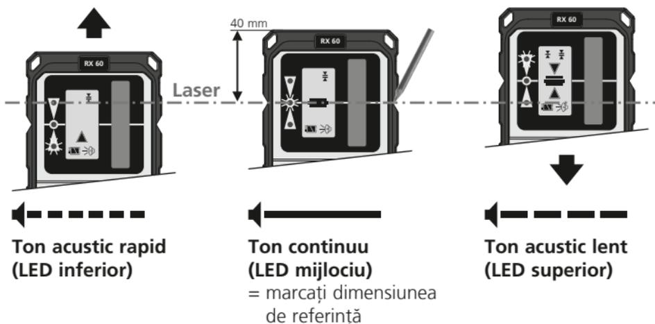
**!** Intensitatea luminii liniilor laser este maximă în mijloc și se reduce în capetele laterale. În acest fel se poate reduce zona de recepție maximă a receptorului laser.
