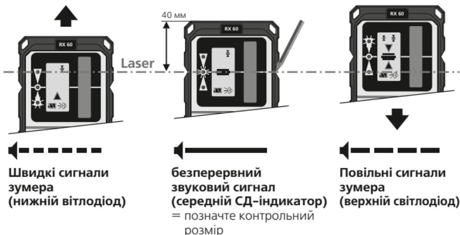
**!** На найбільшій інтенсивності світла лазерний промінь має в центрі, а ближче до країв промінь тускніє. Таким чином можна зменшити максимальну зону прийому лазерного приймача.
