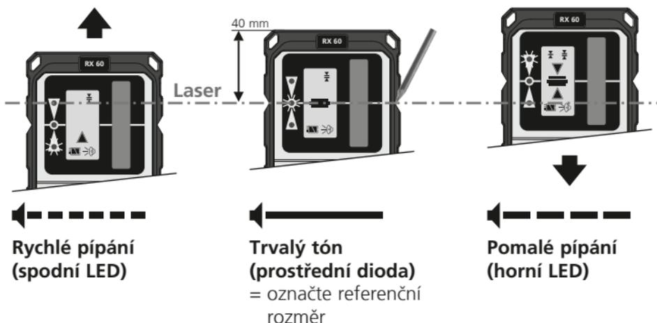
! Světelná intenzita laserových linií je ve středu nejvyšší, na koncích je nižší. Tím se může snížit maximální rozsah příjmu laserového přijímače.
