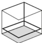
Освободете транспортното укрепване, поставете плъзгачия превключвател (2) в ляво положение. Показва се лазерната линия.
