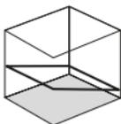
Nemojte otpustiti transportno osiguranje; pomaknite kliznu sklopku (2) udesno i uključite laser pomoću tipke 7. Sada možete izraditi kose ravnine, odn. nagibe. U ovom modusu laserska se linija više ne centrira automatski. To se signalizira treperenjem laserske linije.
