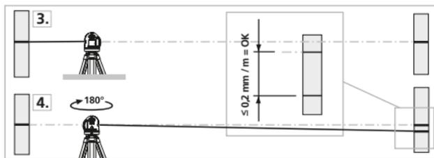
**!** Pokud jsou body A2 a A3 od sebe vzdáleny více než  $0,2 \text{ mm / m}$ , je nutné provést kalibraci. Spojte se s Vaším specializovaným prodejcem nebo využijte servisního oddělení společnosti UMAREX-LASERLINER.
