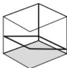
Не освобождавайте работното осигуряване, избутайте плъзгачия превключвател (2) надясно и включете лазера с бутон 7. Сега може да се създадат наклонени равнини, съотв. наклони. В този режим лазерната линия не се подравнява автоматично. Това се сигнализира чрез мигане на лазерната линия.
