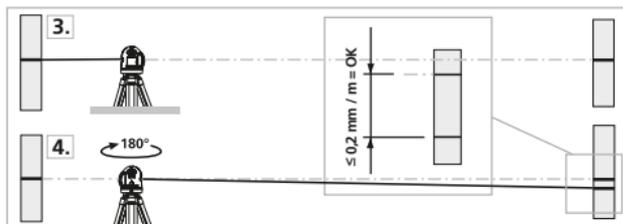
! Dacă A2 și A3 se află la o distanță mai mare de 0,2 mm / m, trebuie efectuată o ajustare. Contactați un comerciant specializat și adresați-vă departamentului service UMAREX-LASERLINER.
