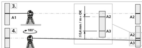
**!** Pokud jsou body A2 a A3 od sebe vzdáleny více než 0,4 mm / m, je nutné provést kalibraci. Spojte se s Vaším specializovaným prodejcem nebo využijte servisního oddělení společnosti UMAREX-LASERLINER.
