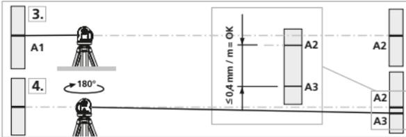
**!** Jos A2 ja A3 ovat toisistaan etäämmällä kuin 0,4 mm / m, on säätö tarpeen. Ota yhteys paikalliseen laitetoimittajaan tai UMAREX-LASERLINER huolto-osastoon.
