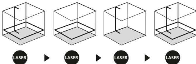
**!** Vid horisontell och vertikal nivellering måste transportsäkringen lossas. Så fort enheten befinner sig utanför det automatiska nivelleringsområdet på 3°, blinkar laserlinjerna och lysdioden tänds i röd färg. Positionera enheten på ett sådant sätt, att den befinner sig inom nivelleringsområdet. Lysdioden växlar över till grön igen och laserlinjerna lyser konstant.
