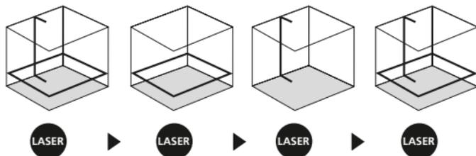
! Horisontal og vertikal nivellering krever at transportsikringen løsnes. Straks apparatet befinner seg utenfor det automatiske nivelleringsområdet på 3°, blinker laserlinjene og LED-en lyser rødt. Posisjoner apparatet slik at det befinner seg innenfor nivelleringsområdet. LED-en lyser grønt igjen og laserlinjene lyser konstant.
