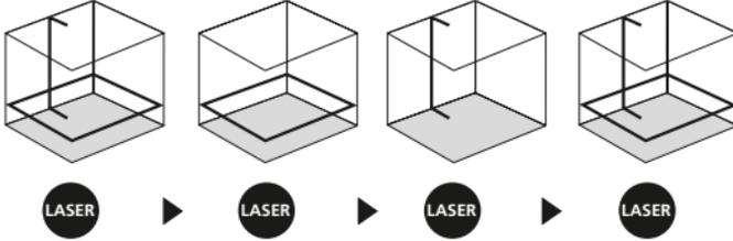
! Yatay ve düşey düzeçleme için taşıma emniyetinin çözülmüş olması gerekmektedir. Cihaz otomatik düzeçleme aralığı olan 3°'nin dışında bulunduğu zaman, lazer çizgileri yanıp sönmeye başlarlar ve LED kırmızı yanar. Cihazı düzeçleme aralığı içinde bulunacak şekilde konumlandırınız. LED yine yeşile döner ve lazer çizgileri sabit yanarlar.
