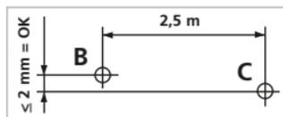
**!** Verifique regularmente a calibragem antes de usar, após transportes e depois de armazenar durante bastante tempo.
