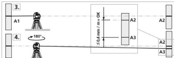
**!** Om A2 och A3 ligger mer än 0,4 mm / m från varandra behöver enheten justeras. Kontakta er återförsäljare eller vänd er till serviceavdelningen på UMAREX-LASERLINER.
