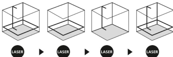
**!** Для горизонтального и вертикального нивелирования необходимо снять с блокировки фиксатор для транспортировки. Как только прибор окажется за пределами автоматического диапазона нивелирования, равного  $3^\circ$ , лазерные линии и светодиод начинают гореть красным цветом. Позиционировать прибор так, чтобы он находился в пределах диапазона нивелирования. Светодиод снова изменяет свой цвет на зеленый, а лазерные линии светятся постоянно.
