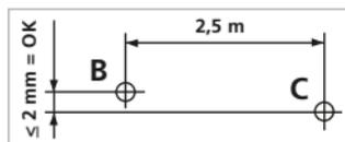
**!** Před použitím, po přepravě a po dlouhém skladování pravidelně kontrolujte kalibraci.
