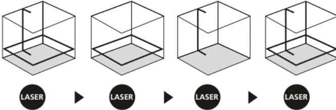
! Vaaka- ja pystysuuntaan tasaamista varten tulee kuljetusvarmistuksen olla vapautettuna. Kun laite on automaattisen tasausalueen 3° ulkopuolella, laserviivat vilkkuvat ja punainen LED-valo syttyy. Sijoita laite tasaiselle alustalle niin, että laite on tasausalueella. Vihreä LED-valo syttyy ja laserviivat palavat jatkuvasti.
