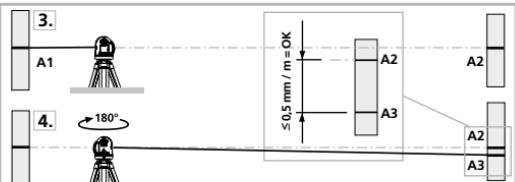
! Om A2 och A3 ligger mer än 0,5 mm / m från varandra behöver enheten justeras. Kontakta er återförsäljare eller vänd er till serviceavdelningen på UMAREX-LASERLINER.
