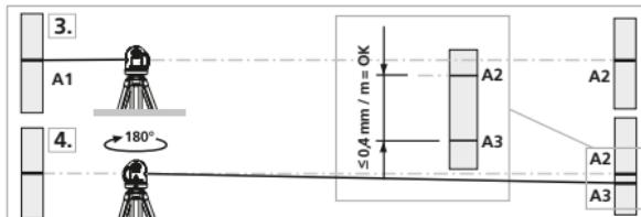
! Jos A2 ja A3 ovat toisiaan etäämmällä kuin  $0,35 \text{ mm} / \text{m}$ , on säätö tarpeen. Ota yhteys paikalliseen laitetoimittajaan tai UMAREX-LASERLINER huolto-osastoon.
