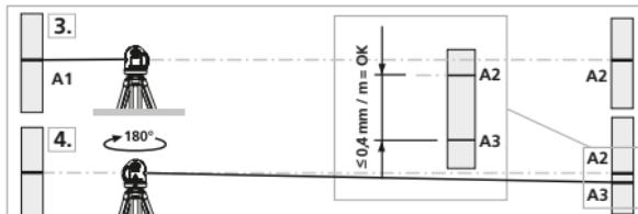
! Om A2 och A3 ligger mer än 0,35 mm / m från varandra behöver enheten justeras. Kontakta er återförsäljare eller vänd er till serviceavdelningen på UMAREX-LASERLINER.
