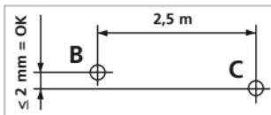
Необходимо регулярно проверять калибровку перед использованием, после транспортировки и длительного хранения.
