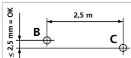
Sprawdzić, czy punkty B i C leżą w poziomie (tolerancia  $\pm 2,5$  mm). Pomiar powtórzyć przesuwając laser w lewo.
