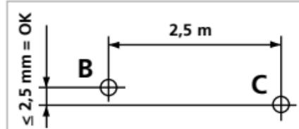
laserkrydset drejes ca. 2,5 m til højre. Den vandrette streg må ikke afvige mere end  $\pm 2,5$  mm fra markeringen af krydspunktet. Proceduren gentages med laserkrydset drejet 2,5 m til venstre.
