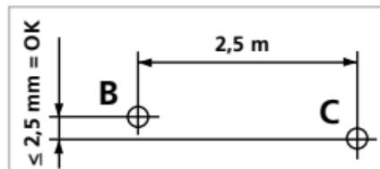
markieren. Laserkreuz ca. 2,5 m nach rechts schwenken und Punkt C markieren. Überprüfen Sie, ob waagerechte Linie von Punkt C  $\pm 2,5$  mm auf der gleichen Höhe mit dem Punkt B liegt. Vorgang durch Schwenken nach links wiederholen.
