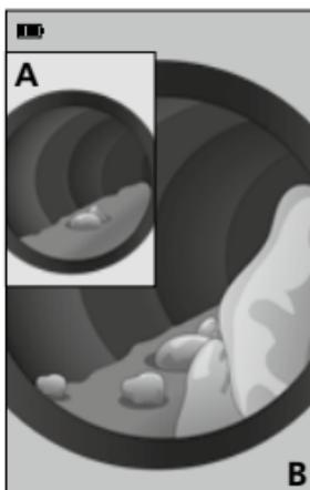
4. Det udvalgte referencebillede (A) vises på displayet, i baggrunden vises livebilledelet (B) til sammenligning.
