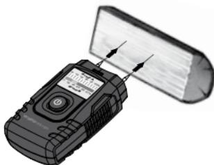
L'emplacement à mesurer doit être non traité et exempt de branches, de saletés ou de résine. Ne pas effectuer de mesure sur les surfaces d'attaque étant donné que le bois sèche particulièrement vite à cet endroit et que cela pourrait fausser les résultats de mesure.
