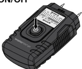
Apparatet slukker automatisk efter 3 minutter for at spare batteri. Herefter tænder man apparatet på ny ved at trykke på Tænd/Sluk-kontakten.
