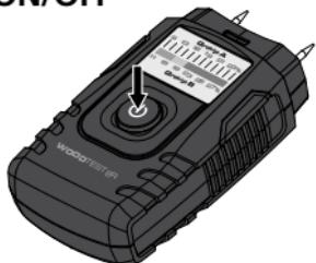
L'apparecchio si spegne automaticamente dopo 3 minuti per conservare le batterie. Per riaccendere l'apparecchio, premere nuovamente l'interruttore on/off.
