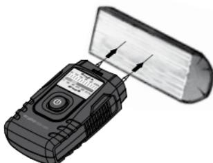
De te meten plek dient onbehandeld en vrij van takken, verontreinigingen of hars te zijn. Er dient géén meting aan de kopezijden te worden uitgevoerd omdat het hout hier bijzonder snel droogt, hetgeen zou leiden tot vervalste meetresultaten.
