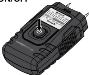
Η συσκευή απενεργοποιείται αυτόματα, μετά από 3 λεπτά για να διαφυλάσσονται οι μπαταρίες. Για να ενεργοποιήσετε στη συνέχεια πάλι τη συσκευή, πιέστε το διακόπτη On/Off.
