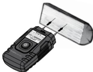
Mjesto gdje se obavlja mjerjenje treba biti neobrađeno, bez kvrga, nečistoća i smole. Mjerjenja se ne bi trebala obavljati na krajnjim rubovima drva jer se ta područja najbrže suše pa se dobiju netočni rezultati mjerjenja.
