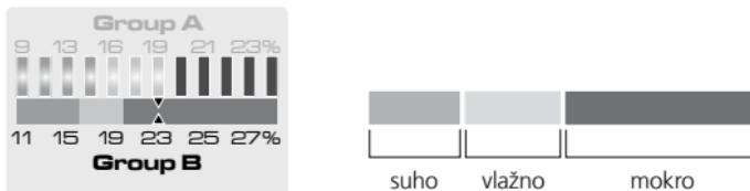
Izvodi li se mjerenje kod vrsta drva grupe B, tada se vlaga u materijalu može očitati u % na donjoj skali. Kako bi se utvrdilo treba li drvo razvrstati kao „suho“, „vlažno“ ili „mokro“, primjenjuje se visina otklona LED-ova, koja se neovisno o njihovoj boji uspoređuje s donjom skalom u boji. Procjena se zatim vrši preko donje skale u boji. Zelena = suho, žuta = vlažno, crvena = mokro. Primjer ovdje: 23%, crveno područje donje skale = mokro.
