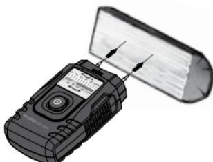
Mõõdetavala peaks olema töötlemata ja vaba okstest, mustusest ja vaigust. Ärge mõõtke esipoolel, kuna seal kuivab puit kõige kiiremini ja seetõttu võivad mõõteväärused olla valed.
