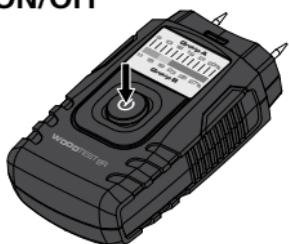
Naprava se po 3 minutah samodejno izključi zaradi varčevanja z baterijo. Če želite napravo po tem znova vključiti, ponovno pritisnite stikalo za vklop/izklop.
