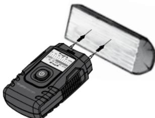
На мястото на измерване не трябва да има резки, замърсявания или смола. Не трябва да се извършват измервания на лицевите страни, понеже на такива места дървото изсъхва много бързо, което води до неверни резултати от измерването.
