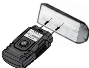
A mérendő helynek kezeletlennek, és ágaktól, kosztól vagy gyantától mentesnek kell lennie. Ne végezzen méréseket a homlokfelületeken, mivel a fa itt különösen gyorsan szárad, és így a mérés hamis eredményt adhat.
