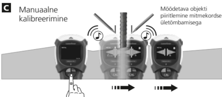
Vihje 1: Metallist objekti keskoht paikneb kahe märgistuse vahel. Kõrge mõõtetundlikkuse tõttu tunduvad jämedad metallobjektid laiemad kui tegelikkuses. Seetõttu liigutage seade uuesti üle leitud mõõdetava objekti, vt joonist B. Seade kalibreeritakse seejuures automaatselt. Manuaalset kalibreerimist tuleks teostada viimati leitud koha lähedal, vt joonist C. Korrake vajadusel toimimisviisi.
