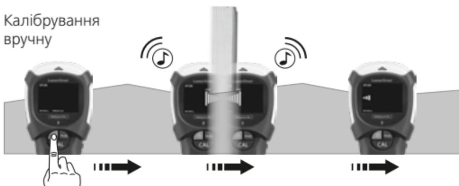
Вказівка 1: Позначка «EDGE» приладу вказує на краї балки, а «CENTER» — на центр балки.
