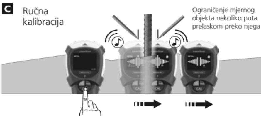
Savjet 1: Sredina metalnog predmeta je između dvije oznake. Zbog visoke osjetljivosti mjerenja, debeli metalni predmeti izgledaju širi nego što stvarno jesu. Stoga ponovno pomaknite uređaj preko pronađenog mjernog objekta, pogledajte sliku B. Uređaj se automatski kalibrira. Ručnu kalibraciju treba izvršiti u blizini zadnje pronađene lokacije, pogledajte Grafikon C. Po potrebi ponovite ove postupke.
