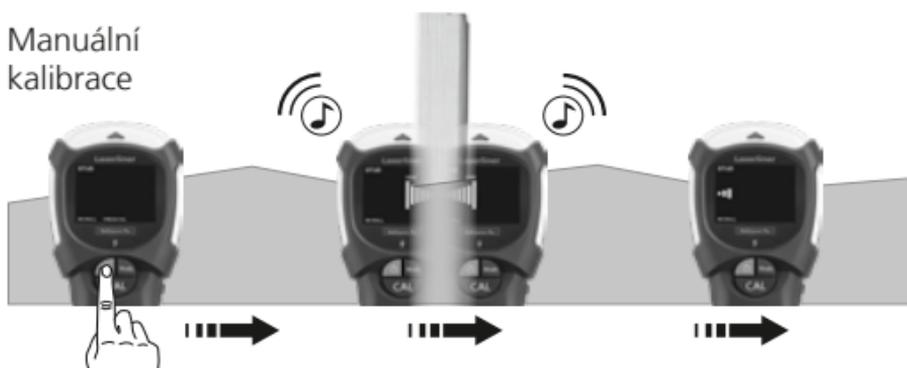
Tip 1: Přístroj pomocí „EDGE“ zobrazuje hrany trámu a pomocí „CENTER“ střed trámu.
