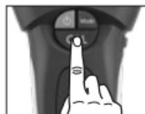
Максимална чувствителност на уреда се получава, когато по време на калибрирането уредът се държи във въздуха. Това може да бъде целесъобразно за измервания в режими METAL и AC-SCAN.
