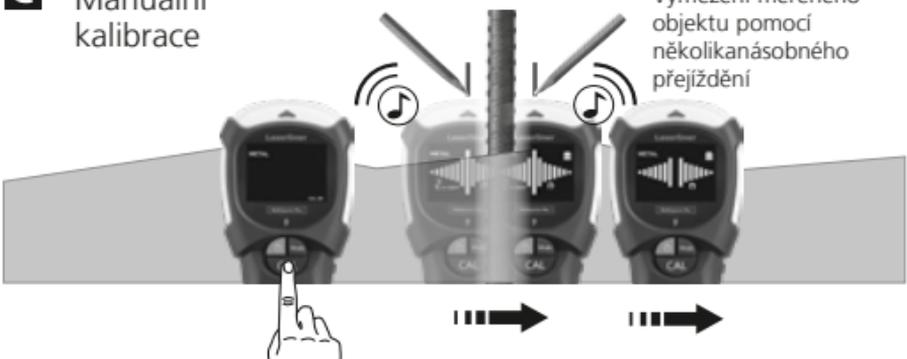
Tip 1: Mezi oběma značkami je střed kovového objektu. Díky vysoké citlivosti měření se silné kovové objekty jeví širší než ve skutečnosti. Proto přístrojem znovu pohybujte přes nalezený měřený objekt, viz obrázek B. Přístroj se přitom kalibruje automaticky. Manuální kalibrace by se měla provést v blízkosti naposledy nalezeného místa, viz obrázek C. V případě potřeby tento postup opakujte.
