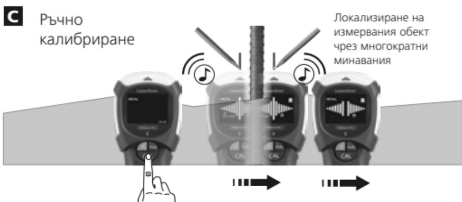
Съвет 1: Между двете маркировки се намира средата на металния обект. Поради високата чувствителност при измерване, дебели метални обекти се явяват по-широки отколкото са в действителност. За повторно преминаване на уреда над открития обект, вижте графика В. Уредът се калибрира автоматично. Ръчното калибриране трябва да се извърши в близост до последното открито място, вижте графика С. При необходимост тези процедури се повтарят.
