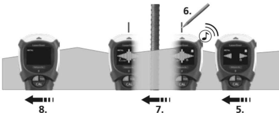
**B** **AUTO CAL PLUS** Локалізування вимірюваного об'єкту шляхом кількох пересувань зоною пошуку
