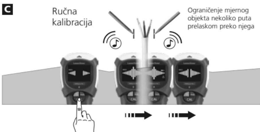
Savjet 1: Ručnu kalibraciju treba izvršiti blizu zadnje pronađene točke, pogledajte grafikon B/C. Po potrebi ponovite ove postupke.
