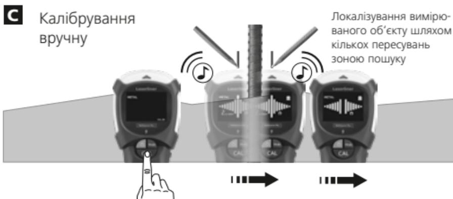
Вказівка 1: позиція між точками – середня точка металевого об'єкту. Через високу чутливість вимірювань металеві об'єкти здаються товщими, ніж є насправді. Тому прилад знову рухають над знайденим вимірюваним об'єктом (див. малюнок В). При цьому прилад автоматично калібрується. Калібрування вручну слід здійснити поблизу від останнього знайденого місця (див. малюнок С). Повторити цю процедуру за необхідністю.
