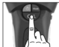
Maximální citlivosti přístroje se docílí, když se přístroj při kalibraci drží ve vzduchu. Může to být místy účelné u měření METAL- a AC-SCAN.
