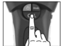
Για να επιτευχθεί η μέγιστη ευαισθησία της συσκευής, κρατήστε τη συσκευή στον αέρα κατά τη βαθμονόμηση. Αυτό μπορεί να είναι εν μέρει καλό για ορισμένες μετρήσεις METAL και AC-SCAN.
