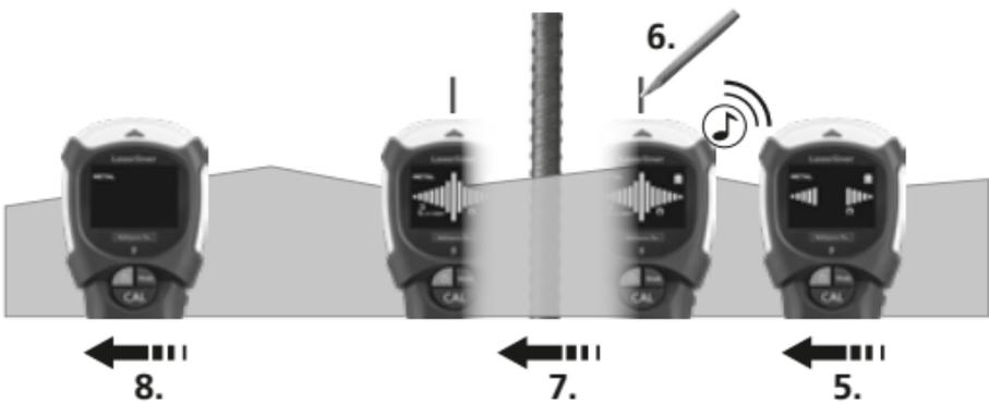
**B** **AUTO CAL PLUS** Vymezení měřeného objektu pomocí několikanásobného přejíždění
