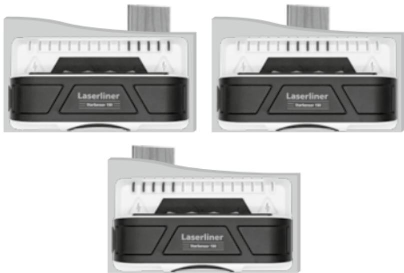
**Výstraha před střídavým napětím:** Symboly blesku se rozsvítí, aby indikovaly přítomnost vedení pod napětím.
