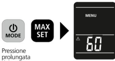
Tenendo premuti contemporaneamente i tasti ON/OFF e MAX, si accede al menu. In quest'ultimo è possibile impostare il valore di soglia di asciuttamento, la segnalazione e lo spegnimento automatico.
