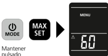
Pulsando ON/OFF y MAX a la vez, se accede al menú. En él se puede ajustar el valor umbral para seco, la alarma y el apagado automático.
