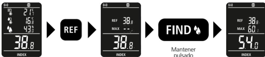
Con la función de referencia puede hacerse una idea de la extensión de la humedad en la pared. Busque un punto seco en el objeto que desea medir y detecte la humedad del modo descrito en el capítulo 6 «Procedimiento de medición». Para grabar el valor de medición como valor de referencia pulse el botón "REF". Mida la humedad en otro punto. Obtendrá un cuadro general del valor de referencia, el valor máximo y el valor de medición actual.
