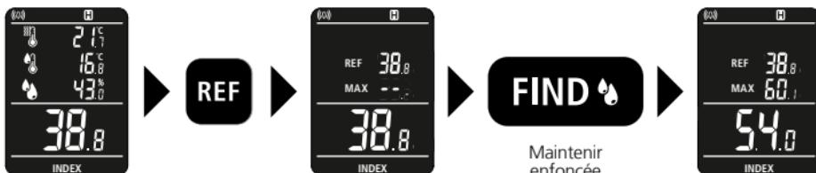
La fonction de référence vous permet d'avoir un aperçu de la réparation de l'humidité dans le mur. Cherchez un endroit sec sur le matériau à mesurer et déterminez la teneur en humidité comme décrit au chapitre 6 « Procédure de mesure ». Conservez la valeur mesurée comme valeur de référence en appuyant sur la touche « REF ». Procédez à une mesure de l'humidité à un autre endroit. Vous obtenez un aperçu de la valeur de référence, de la valeur mesurée maximale et de la valeur mesurée actuelle.
