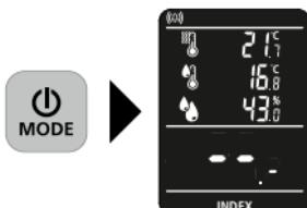
La modalità Index serve a individuare rapidamente l'umidità tramite misure di confronto senza l'output diretto dell'umidità del materiale in %. Il valore indicato (da 0 a 199,9) è un valore indicizzato che aumenta all'aumentare dell'umidità del materiale. Le misure eseguite in modalità Index non dipendono
