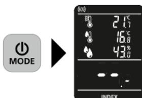
Le mode Index sert à repérer rapidement de l'humidité en procédant à des mesures comparatives sans indiquer directement l'humidité du matériau en %. La valeur indiquée (0 à 199,9) est une valeur indicée qui augmente lorsque l'humidité du matériau augmente. Les mesures effectuées en mode Index
