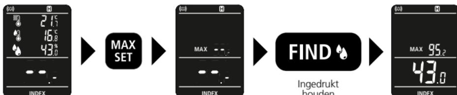
Het toestel kan de MAX-waarde slechts binnen één meetproces vasthouden. Na het meetproces wordt de MAX-waarde weergegeven. Wanneer u een nieuwe meting uitvoert door de toets 'FIND' ingedrukt te houden, worden de MAX-waarde en de huidige waarde weergegeven.
