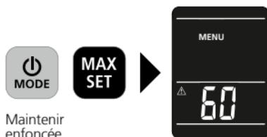
Maintenez simultanément les touches ON/OFF et SET enfoncées pour accéder au menu. Il est ici possible de régler la valeur seuil sec, l'alarme et l'arrêt automatique.
