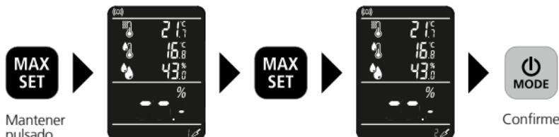
Hay 3 grupos de materiales: solado de cemento, solado de anhidrita y hormigón en Masa % y CM %. Al reiniciar, se mantiene el último material utilizado.
