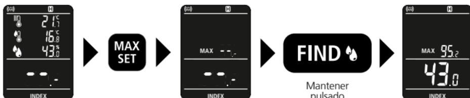
El dispositivo solo puede conservar el valor MAX dentro de un proceso de medición. Finalizado el proceso, se muestra el valor MAX. Al realizar una nueva medición manteniendo pulsado el botón "FIND", se muestran el valor MAX y el valor actual.
