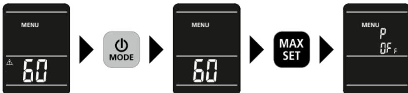
Das Gerät verfügt über eine automatische Abschaltung. Sie kann nach 3 Minuten oder 60 Minuten erfolgen. Für den Einsatz des Gerätes als Hygrometer zur Überwachung des Raumklimas ist die Einstellung der automatischen Abschaltung nach 60 Minuten sinnvoll.
