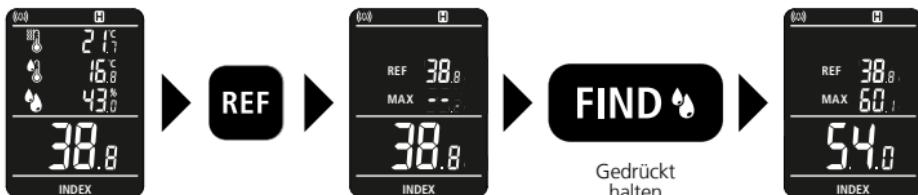
Mit Referenz-Funktion können Sie sich einen Überblick über die Feuchtigkeitsverteilung in der Wand verschaffen. Suchen Sie eine trockene Stelle am Messgut und ermitteln Sie den Feuchtigkeitsgehalt wie in Kapitel 6 "Messvorgang" beschrieben. Halten Sie den Messwert durch Drücken der Taste "REF" als Referenzwert fest. Führen Sie eine Feuchtigkeitsmessung an einer anderen Stelle durch. Sie erhalten eine Übersicht von Referenzwert, maximalem Messwert und aktuellem Messwert.
