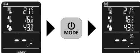
Het apparaat beschikt over 2 modi voor de vochtmeting, al naargelang het materiaal. Met een druk op de toets 'MODE' kan worden omgeschakeld tussen de centrale, materiaalafhankelijke INDEX-modus en de aanvullende bouwmateriaalmodus.
