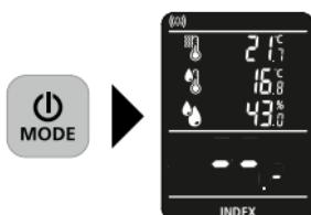
De **indexmodus** is bedoeld voor het snel opsporen van vocht door middel van vergelijkende metingen, **zonder** de directe uitvoer van het materiaalvocht in %. De uitgegeven waarde (0 t/m 199,9) is een indicatieve waarde die stijgt bij toenemend materiaalvocht. De metingen die in de indexmodus
