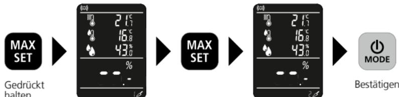
Es gibt 3 Materialgruppen: Zementestrich, Anhydritestrich und Beton jeweils in Masse-% und CM-%. Nach einem Neustart wird das zuletzt verwendete Material beibehalten.
