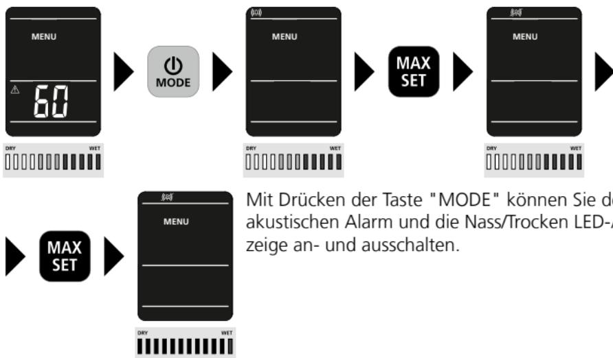
Mit Drücken der Taste "MODE" können Sie den akustischen Alarm und die Nass/Trocken LED-Anzeige an- und ausschalten.
