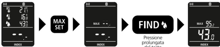
Il dispositivo è in grado di mantenere il valore MAX solo nell'ambito di una procedura di misurazione. Dopo la misurazione verrà visualizzato il valore MAX. Se si effettua una nuova misurazione tenendo premuto il tasto "FIND", verranno visualizzati il valore MAX e il valore corrente.
