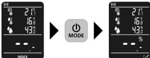
L'instrument dispose de 2 modes de mesure de l'humidité en fonction du matériau. Appuyez sur la touche « MODE » pour passer entre le mode INDEX central indépendant du matériau et le mode Matériau de construction supplémentaire.
