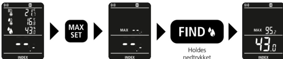
Apparatet kan kun holde MAX-værdien inden for en måling. Efter målingen vises MAX-værdien. Ved en ny måling med nedtrykket "FIND"-taste vises MAX-værdien og den aktuelle værdi.
