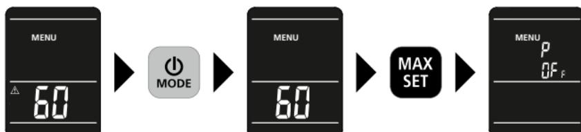
Apparatet råder over en automatisk frakobling. Den kan finde sted efter 3 minutter eller 60 minutter. For anvendelse af apparatet som hygrometer til overvågning af indeklimaet er indstilling af den automatiske frakobling efter 60 min. hensigtsmæssig.
