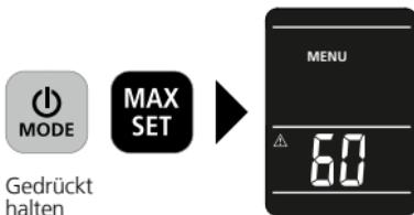
Durch gleichzeitiges Gedrückthalten der ON/OFF- und MAX-Taste gelangt man in das Menü. Hier kann man den Trocken-Schwellenwert, den Alarm und die Auto Abschaltung einstellen.
