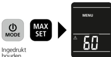
Houd de ON/OFF- en MAX-toets tegelijkertijd ingedrukt om het menu te openen. Hier kunt u de droog-drempelwaarde, het alarm en de automatische uitschakeling instellen.
