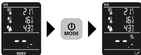
L'apparecchio ha 2 modalità per la misurazione dell'umidità in funzione del tipo di materiale. Tramite il tasto "MODE" è possibile passare dalla modalità INDEX principale, indipendente dal materiale, alla modalità aggiuntiva Materiali da costruzione.
