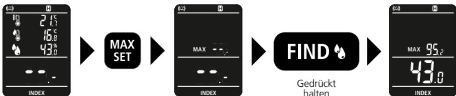
Das Gerät kann den MAX-Wert nur innerhalb eines Messvorganges halten. Nach dem Messvorgang wird der MAX-Wert angezeigt. Bei erneutem Messen durch Gedrückthalten der Taste "FIND" werden der MAX-Wert und der aktuelle Wert angezeigt.
