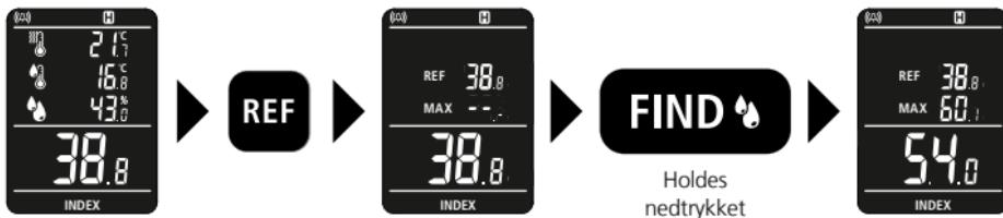
Med referencefunktionen kan du danne dig et overblik over fugtfordelingen i væggen. Find et tørt sted på måleemnet, og mål derefter fugtindholdet, som beskrevet i kapitel 6 "Måling". Fasthold måleværdien ved tryk på "REF"-tasten. Gennemfør også en fugtmåling på et andet sted. Der vises en oversigt over referenceværdien, den maksimale måleværdi og den aktuelle måleværdi.
