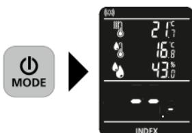
Der **Index-Modus** dient zum schnellen Aufspüren von Feuchtigkeit durch Vergleichsmessungen, **ohne** die direkte Ausgabe der Materialfeuchte in %. Der ausgegebene Wert (0 bis 199,9) ist ein indizierter Wert, der mit zunehmender Materialfeuchte steigt. Die Messungen, die im Index-Modus vorgenommen
