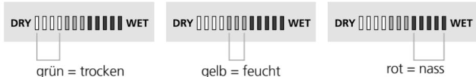
! Die Einstufung „trocken“ bedeutet, dass die Materialien in einem beheizten Raum die Ausgleichsfeuchte erreicht haben und somit in der Regel für die weitere Verarbeitung geeignet sind.
