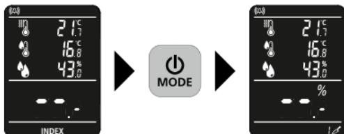
El aparato dispone de 2 modos de medición de la humedad para los distintos materiales. Pulsando el botón "MODE" se pasa del modo central INDEX independiente del material al modo adicional Material de construcción.
