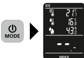
**Index-läget** är avsett för snabb identifiering av fukt genom jämförande mätningar, **utan** att direkt ange fukthalten i materialet i %. Det visade värdet (0 – 199,9) är ett indicerat värde som ökar med tilltagande fuktighet i materialet. De mätningar, som görs i Index-läget, är oberoende av materialet
