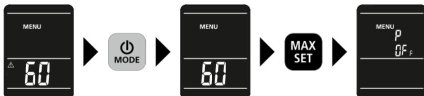
В приборе предусмотрена функция автоматического отключения. Отключение может произойти через 3 минуты или 60 минут. При использовании прибора в качестве гигрометра для контроля параметров микроклимата в помещении рекомендуется настроить автоматическое отключение через 60 минут.
