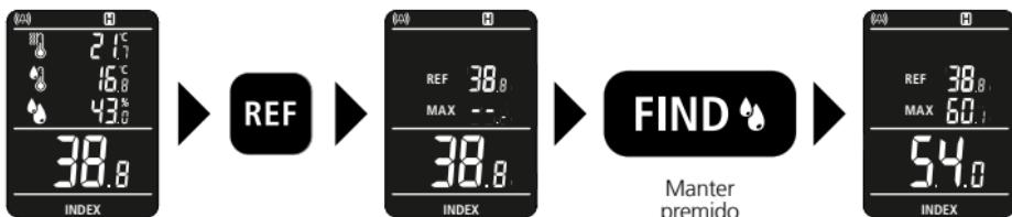
Com a função de referência pode obter uma visão geral da distribuição da humidade na parede. Procure uma parte seca no material a ser medido e determine o teor de humidade como descrito no capítulo 6 "Processo de medição". Mantenha o valor medido como valor de referência ao premir o botão "REF". Efetue uma medição de humidade noutro sítio. A seguir receberá uma visão geral do valor de referência, do valor máximo medido e do valor medido atual.
