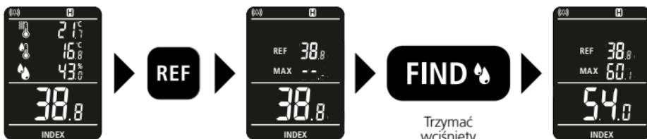
Dzięki zastosowaniu funkcji referencyjnej można uzyskać przegląd rozkładu wilgoci w ścianie. Należy znaleźć suche miejsce na mierzonym materiale, po czym określić wilgotność, jak opisano w rozdziale 6 „Procedura pomiaru”. Naciśnięcie przycisku „REF” umożliwia zachowanie zmierzonej wartości jako wartości referencyjnej. Wykonać pomiar wilgotności w innym miejscu. Wówczas otrzymuje się zestawienie wartości referencyjnej, maksymalnej wartości zmierzonej i aktualnej wartości zmierzonej.
