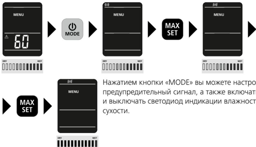
Нажатием кнопки «MODE» вы можете настроить предупредительный сигнал, а также включать и выключать светодиод индикации влажности/сухости.
