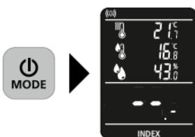
**Режим указателя „Index“** предназначен для быстрого распознавания влажности за счет сравнительных замеров, **не выдавая** напрямую результатов измерения влажности материала в %. Выдаваемое значение (от 0 до 199,9) – это индикаторное значение, которое повышается по мере увеличения влажности материала. Измерения,
