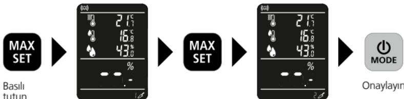
3 malzeme grubu mevcut: Çimento şap, anhidrit şap ve beton her biri % kütle ve % CM olarak. Yeniden başlatıldıktan sonra en son kullanılan malzeme hafızada kalır.
