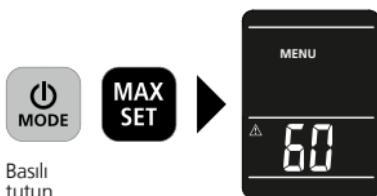
ON/OFF ve MAX tuşları aynı anda basılı tutulduğunda menüye geçilir. Burada kuru eşik değeri, alarm ve otomatik kapanma ayarlanabilir.
