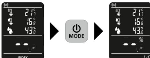
Cihazın malzeme türüne bağlı olarak nem oranı tespiti için 5 ayrı modu vardır. "MODE" tuşuna basılarak merkezi, malzemeye bağlı olmayan ENDEKS modu ile ek yapı malzemesi modu arasında geçiş yapılabilir.
