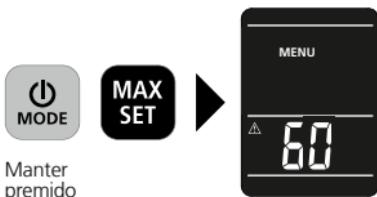
Ao manter simultaneamente premidos os botões ON/OFF e MAX entra-se no menu. Aqui é possível definir o valor limiar de estado seco, o alarme e a desconexão automática.
