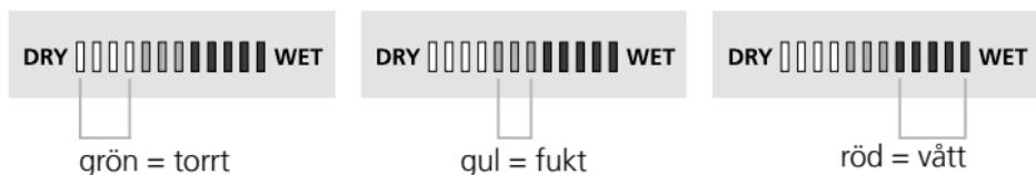
**!** Utslaget "torrt" betyder att materialen i ett uppvärmt rum har uppnått en utjämningsfuktighet och därmed i regel är lämpligt för vidare bearbetning.
