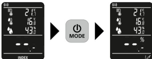
В приборе есть 2 режима измерения влажности в зависимости от материала. Нажатие кнопки «MODE» позволяет выбрать основной режим «INDEX» (для сравнения различных категорий материалов) или дополнительный режим «Стройматериалы».
