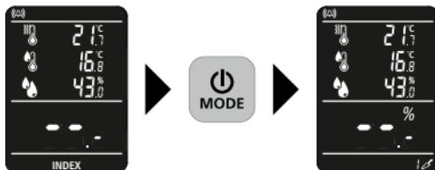
O aparelho dispõe de 2 modos para medir a humidade em função do material. Ao premir o botão "MODE" comuta-se entre o modo INDEX central, independente do material, e o modo material de construção adicional.
