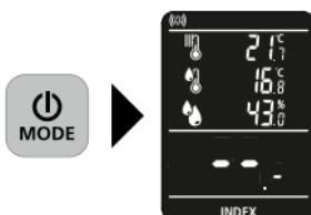
**Tryb indeksowy** służy do szybkiego wyszukiwania wilgości poprzez pomiary porównawcze, **bez** bezpośredniego wskazania wilgotności materiału w procentach. Podana wartość (0 do 199,9) to wartość indeksowa rosnąca wraz ze wzrostem wilgotności materiału. Pomiary dokonywane w trybie indeksowym są niezależne od materiałów i nadają się do materiałów, dla których nie ma wczytanych charakterystyk. Przy dużych odchyłach wartości przy pomiarach porównawczych łatwo jest zlokalizować wilgoć.
