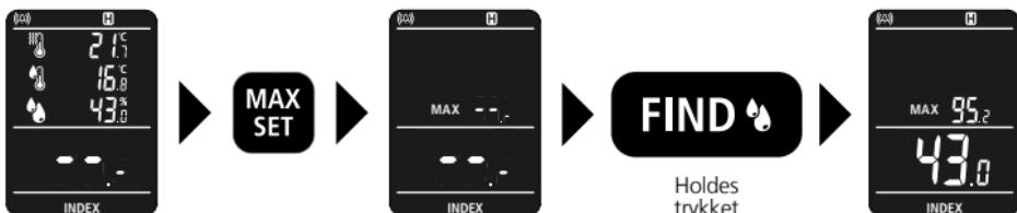
Instrumentet kan bare holde MAX-verdien innenfor én måleprosess. Etter at målingen er gjennomført, vises MAX-verdien. Ved ny måling ved å holde «FIND» knappen trykket, vises MAX-verdien og den aktuelle verdien
