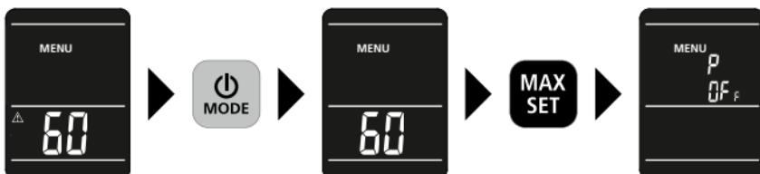
Laitteessa on automaattinen virrankatkaisu. Virrankatkaisu voi tapahtua joko 3 tai 60 minuutin kuluttua. Käytettäessä laitetta kosteusmittarina sisäilmän valvontaan, on järkevää säätää automaattinen virrankatkaisu 60 minuutin kohdalle.
