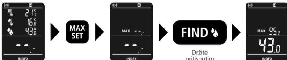
Uređaj može držati MAKS. vrijednost samo unutar postupka mjerjenja. MAKS. vrijednost prikazuje se nakon postupka mjerjenja. Pritiskom na tipku „FIND“ prilikom ponovnog mjerjenja prikazuju se MAKS. vrijednost i aktualna vrijednost.
