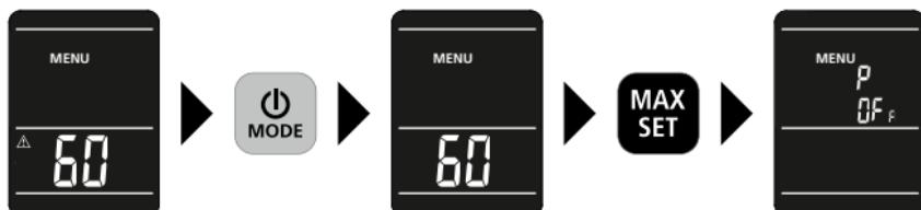
Uređaj raspolaže automatskim isključivanjem. Ono može uslijediti nakon 3 minute ili nakon 60 minuta. Za primjenu uređaja kao higrometra radi nadzora klime u prostoriji preporučuje se namještanje automatskog isključivanja nakon 60 minuta.
