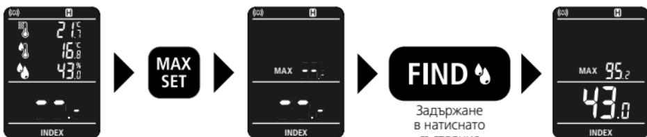
Уредът може да запазва максималната стойност само в рамките на измерването. Максималната стойност се показва след завършването на измерването. При следващо измерване чрез задържане в натиснатото състояние на бутона „FIND“ се показват максималната стойност и текущата стойност.
