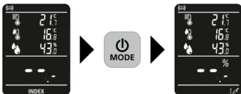
Прилад має 2 режими вимірювання вологості, в залежності від матеріалу. Натискання кнопки MODE дозволяє вибрати основний режим INDEX (для порівняння різних категорій матеріалів) або додатковий режим «Будматеріали».
