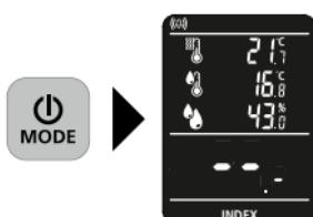
**Indexový režim** slouží pro rychlé vyhledání vlhkosti pomocí srovnávacích měření, **bez** přímého udání vlhkosti materiálu v %. Uvedená hodnota (0 až 199,9) je indikovaná hodnota, která stoupá se vzrůstající vlhkostí materiálu. Měření prováděná v indexovém režimu, jsou nezávislá na materiélech, resp.
