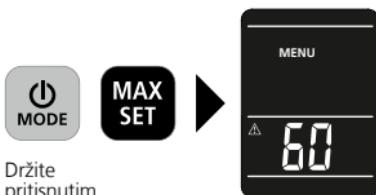
U izborniku se dospijeva istovremenim pritiskanjem tipki ON/OFF i MAX. Ovdje je moguće namjestiti vrijednost praga za suho, alarm i automatsko isključivanje.
