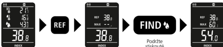
Pomocí referenční funkce lze získat přehled o rozložení vlhkosti ve stěně. Najdete suché místo na měřeném materiálu a zjistěte obsah vlhkosti podle popisu v kapitole 6 „Proces měření“. Stisknutím tlačítka „REF“ stanovte naměřenou hodnotu jako referenční hodnotu. provedte měření vlhkosti na jiném místě. Tak získáte přehled o referenční hodnotě, maximální naměřené hodnotě a aktuální naměřené hodnotě.
