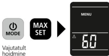
ON/OFF- ja MAX-klahvi samaaegsel vajutatult hoidmisel liigutakse menüüsse. Siin saab seadistada kuiva-piirväärtuse, häire ja automaatse väljalülitumise.
