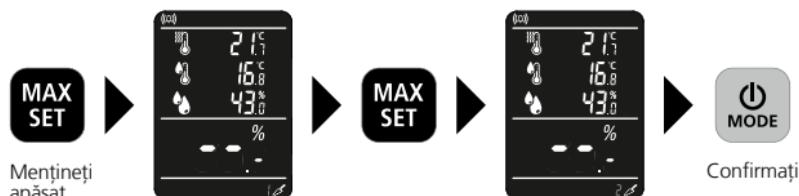
Există 3 grupe de materiale: Șapă de ciment, șapă de anhidrit și beton, fiecare în % masă și CM %. După o repornire, se păstrează stocat ultimul material utilizat.
