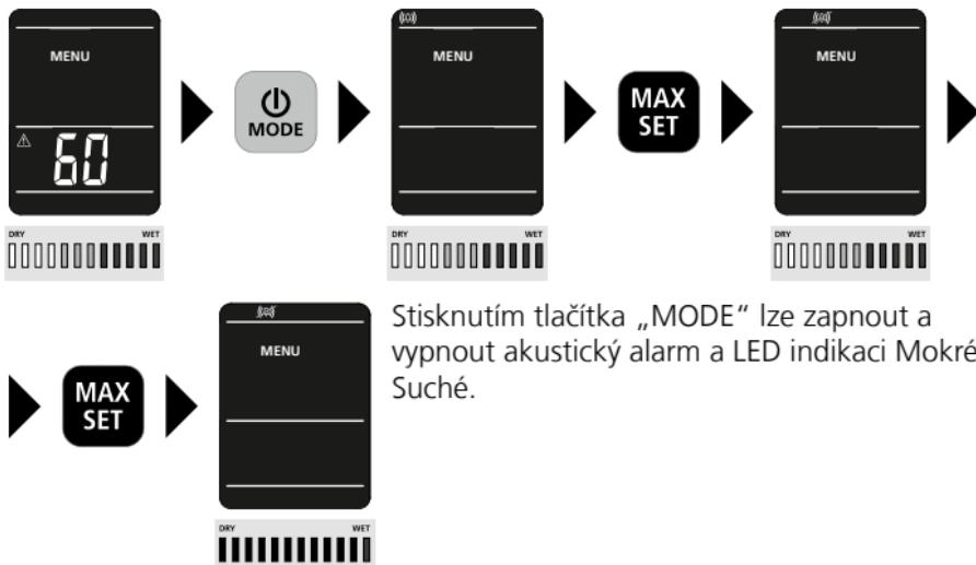
Stisknutím tlačítka „MODE“ lze zapnout a vypnout akustický alarm a LED indikaci Mokré/ Suché.
