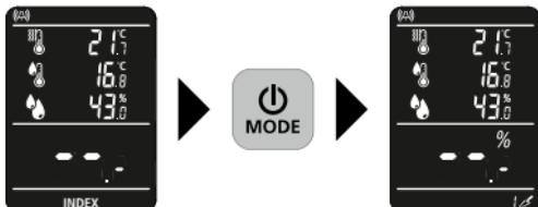
Η συσκευή διαθέτει 2 τρόπους λειτουργίας για τη μέτρηση υγρασίας, συναρτήσει του υλικού. Πιέζοντας το πλήκτρο «MODE» εναλλάσσεσθε ανάμεσα στην κεντρική, ανεξάρτητη από υλικό λειτουργία INDEX και την πρόσθετη λειτουργία για δομικά υλικά.
