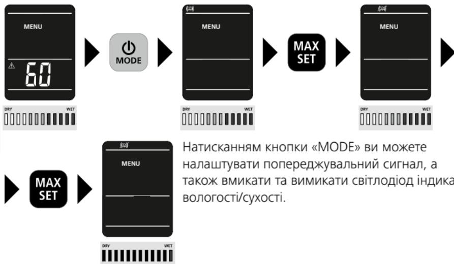
Натисканням кнопки «MODE» ви можете налаштовувати попереджувальний сигнал, а також вмикати та вимикати світлодіод індикації вологості/сухості.
