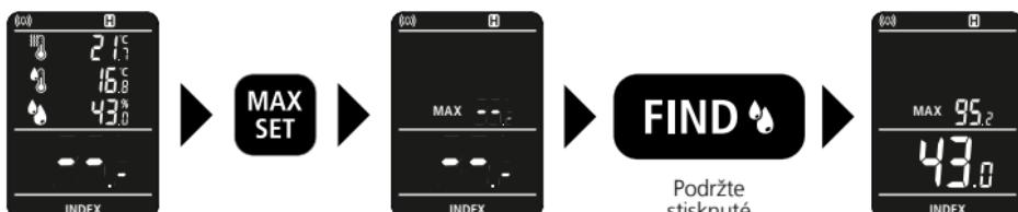
Přístroj dokáže udržet hodnotu MAX jen v rámci jednoho měření. Po ukončení měření se zobrazí hodnota MAX. Při opětovném měření se stisknutím a podržením tlačítka „FIND“ zobrazí hodnota MAX a aktuální hodnota
