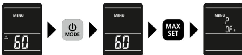
Aparatul dispune de un oprire automată. Acesta poate fi setat să se opreasă după 3 minute sau 60 de minute. Atunci când utilizați aparatul ca higrometru pentru a monitoriza climatul camerei, este logic să setați oprirea automată după 60 de minute.
