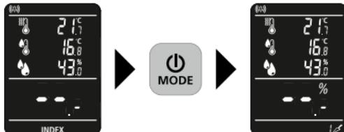
Režim má 2 režimy pro měření vlhkosti, v závislosti na materiuu. Stisknutím tlačítka „MODE“ se přepíná mezi centrálním, materiálově nezávislým režimem INDEX a dodatečným režimem Stavební materiál.
