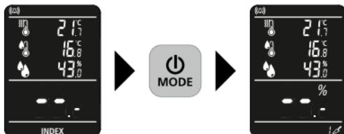
Уредът разполага с 2 режима за измерване на влажност, в зависимост от материала. Чрез натискане на бутона „MODE“ се превключва между централния, независим от материала режим INDEX и допълнителния режим „Строителни материали“.
