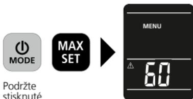
Současným stisknutím a podržením tlačítek ON/OFF a MAX se dostanete do menu. Zde můžete nastavit prahovou hodnotu suchosti, alarm a automatické vypnutí.
