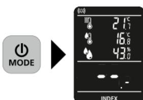
Indeksni način se koristi za brzo otkrivanje vlage putem usporednih mjerena, bez izravnog izlaza sadržaja vlage materijala u %. Vraćena vrijednost (0 do 199,9) je indeksirana vrijednost koja raste s povećanjem vlažnosti materijala. Mjerenja napravljena u indeksnom načinu rada neovisna su o materijalu ili
