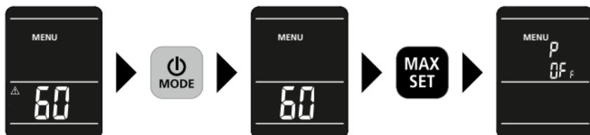
Seade on varustatud automaatse väljalülitusega. See võib toimuda 3 minuti või 60 minuti möödumisel. Seadme hügromeetrina kasutamisel ruumikliima jälgimiseks on mõttetas automaatse väljalülituse seadistus 60 minuti möödumisel.
