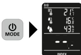
**Режим індексування** служить для швидкого виявлення вологи завдяки порівняльним вимірюванням, **без** прямого виведення вологості матеріалу в %. Виведене значення (від 0 до 199,9) є індексованим значенням, яке збільшується зі зростанням вологості матеріалу. Заміри, які
