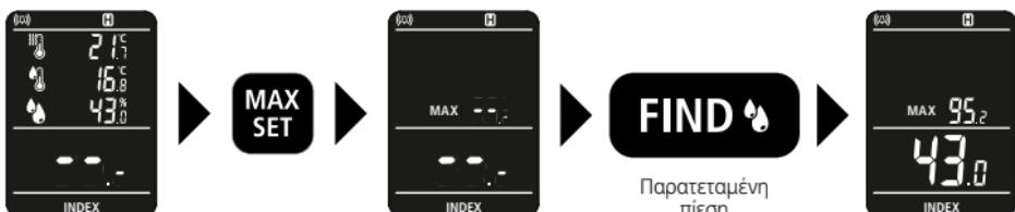
Η συσκευή μπορεί να διατηρεί τη MAX τιμή μόνο εντός μίας διαδικασίας μέτρησης. Μετά από τη διαδικασία μέτρησης εμφανίζεται η MAX τιμή. Σε νέα μέτρηση με παρατεταμένη πίεση του πλήκτρου «FIND» εμφανίζεται η τιμή MAX και η τρέχουσα τιμή.
