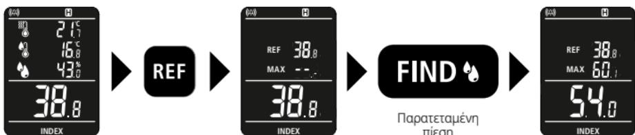
Με τη λειτουργία αναφοράς μπορείτε να έχετε μια επισκόπηση της κατανομής υγρασίας στον τοίχο. Αναζητήστε ένα στεγνό σημείο στο υλικό μέτρησης και βρείτε την περιεκτικότητα υγρασίας όπως περιγράφεται στο κεφάλαιο 6 «Διαδικασία μέτρησης». Συγκρατήστε την τιμή μέτρησης ως τιμή αναφοράς πιεζόντας το πλήκτρο «REF». Εκτελέστε μια μέτρηση υγρασίας σε ένα άλλο σημείο. Θα βρείτε μια επισκόπηση της τιμής αναφοράς, της μέγιστης τιμής μέτρησης και της τρέχουσας τιμής μέτρησης.
