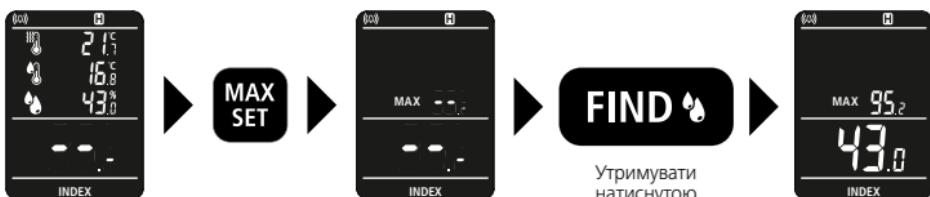
Прилад може зберігати максимальне значення лише протягом одного процесу вимірювання. Після закінчення процесу вимірювання відображається максимальне значення. При повторному вимірюванні (натиснути та утримувати кнопку «FIND») відображається максимальне та поточне значення.
