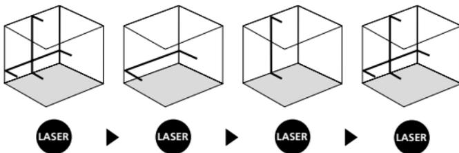
! За хоризонтално и вертикално нивелиране трябва да се освободи транспортното обезопасяване. Щом уредът се намира извън зоната на автоматично нивелиране 3,5°, лазерните линии мигат. Позиционирайте уреда така, че да се намира вътре в зоната на нивелиране. Лазерните линии отново светват постоянно.
