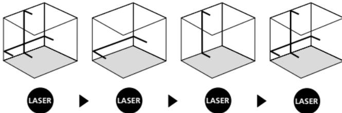
! Horisontaalseks ja vertikaalseks nivelleerimiseks peab olema transpordikaitse vabastatud. Kui seade on väljaspool automaatset nivelleerimisvahemikku  $3,5^\circ$ , siis laserjooned vilguvad. Positioneerige seade nii, et ta paikneks nivelleerimisvahemiku piires. Laserjooned süttivad jälle pidevalt.
