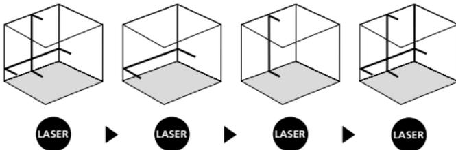
! Pentru nivelarea orizontală și verticală, siguranța pentru transport trebuie să fie îndepărtată. De îndată ce aparatul se află în afara domeniului de nivelare automată de 3,5°, razele laser pâlpâie. Poziționați aparatul astfel încât acesta să se afle în cadrul domeniului de nivelare. Liniile laser se aprind din nou în mod constant.
