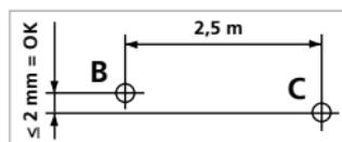
**!** Verificați periodic calibrarea înainte de utilizare, după transportare sau depozitare îndelungată.
