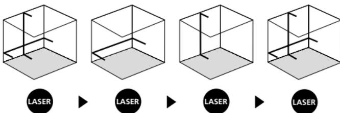
! Для горизонтального і вертикального нівелювання необхідно розфіксувати транспортне стопоріння. У разі виходу за межі діапазону автоматичного нівелювання, що становить  $3,5^\circ$ , лазерні лінії починають блимати. Розташуйте прилад так, щоб він потрапив у межі діапазону автоматичного нівелювання. Лазерні лінії знову загоряються постійно.
