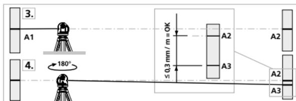
**!** Dacă A2 și A3 se află la o distanță mai mare de 0,3 mm / m, trebuie efectuată o ajustare. Contactați un comerciant specializat și adresați-vă departamentului service UMAREX-LASERLINER.
