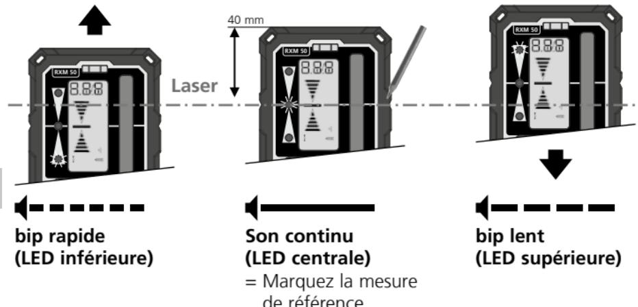
! L'intensité lumineuse des lignes laser est maximale au centre et va en diminuant sur les bords. Cela permet de réduire la plage de réception maximale du récepteur laser.
