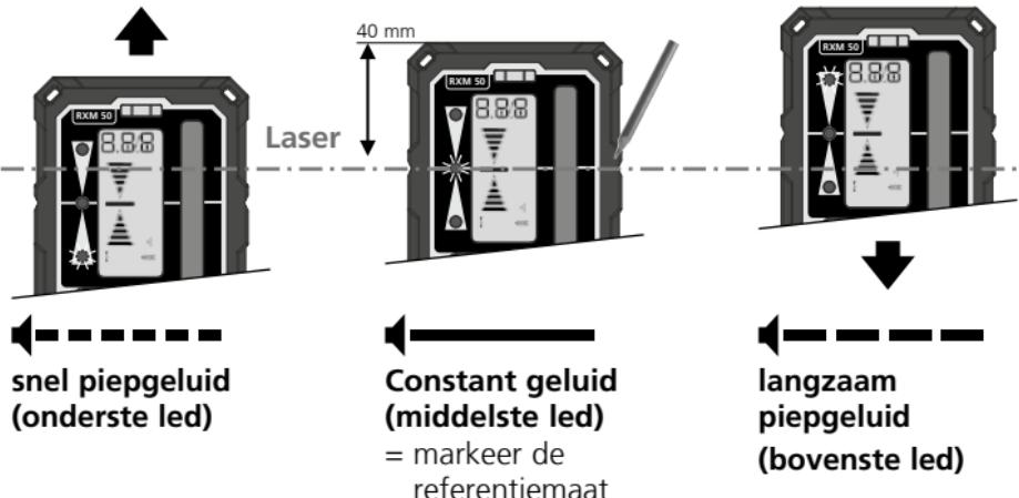
! De lichtintensiteit van de laserlijnen is in het midden het hoogst en neemt af naar de randen toe. Hierdoor kan het maximale ontvangstbereik van de laser worden verminderd.
