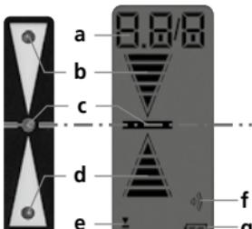
**a** Numerieke afwijking van het laserniveau**b** Handontvanger boven het laserniveau**c** Exact in het laserniveau**d** Handontvanger beneden het laserniveau**e** Nauwkeurigheid (3 standen)**f** Geluidssignaal AAN / UIT**g** Indicator batterij-laadtoestand
