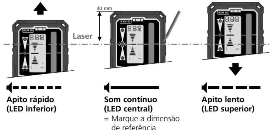
! A intensidade da luz das linhas de laser é maior no meio e menor nas extremidades. Assim é possível que a margem de recepção máxima do receptor laser diminua.
