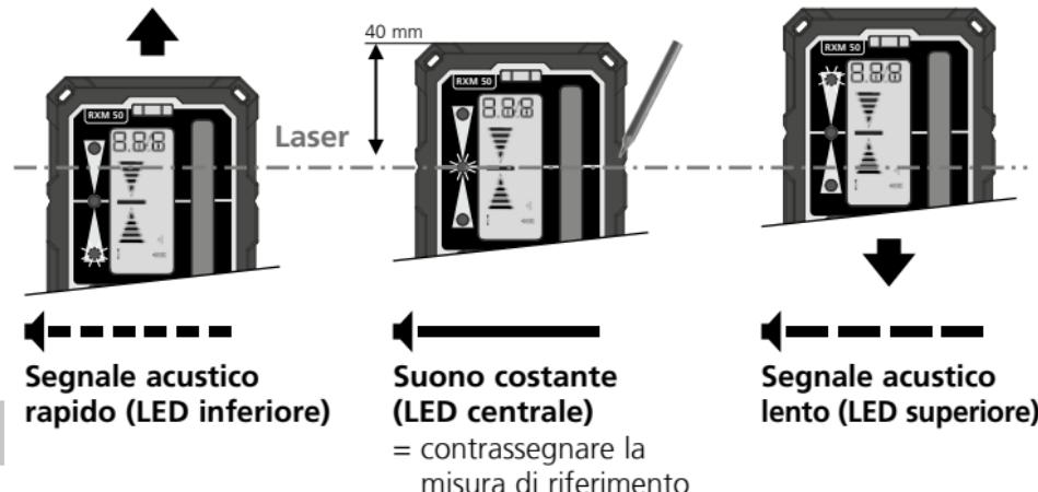
! L'intensità luminosa delle linee laser è massima al centro e si riduce alle estremità. In questo modo può diminuire l'area di ricezione del ricevitore laser.
