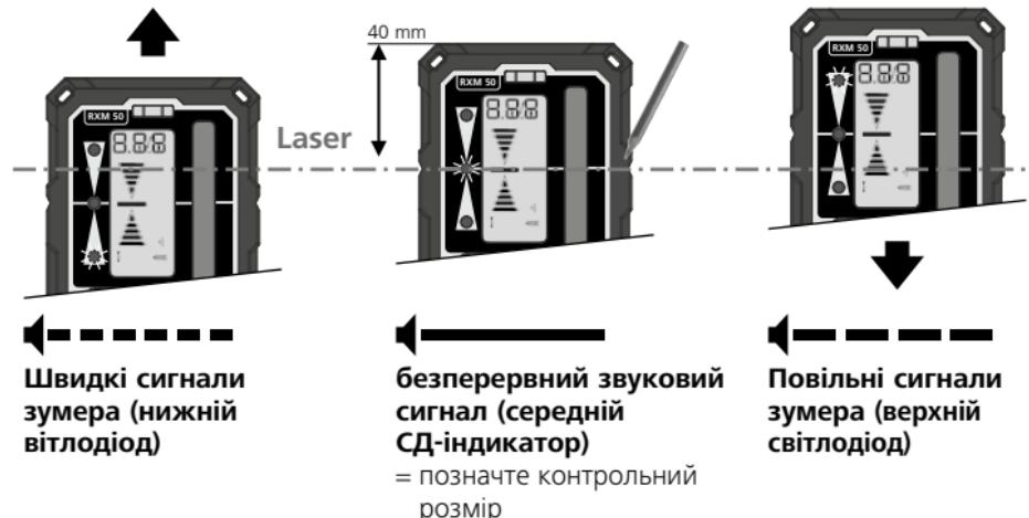
Наибольшую интенсивность света лазерный луч имеет в центре, а ближе к краям луч тускнеет. Таким чином можна зменшити максимальную зону приёма лазерного приёмчика.
