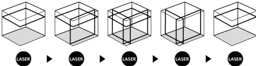
! Yatay ve düşey düzeye çubukları için taşıma emniyetinin çözülmüş olması gerekmektedir. Cihaz otomatik düzeye çubukları aralığı olan 3,5°'nin dışında bulunduğu zaman, lazer çizgileri yanıp sönmeye başlarlar. Cihazı düzeye çubukları aralığı içinde bulunacak şekilde konumlandırınız. Lazer çizgileri tekrar sürekli parlıyor
