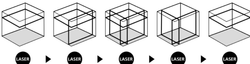
! Para a nivelamento horizontal e vertical é preciso que o bloqueador de transporte esteja solto. Logo que o aparelho se encontre fora da área de nivelamento automática de 3,5°, as linhas de laser piscam. Posicione o aparelho de modo a que se encontre dentro da área de nivelamento. De laser acendem novo constantemente.
