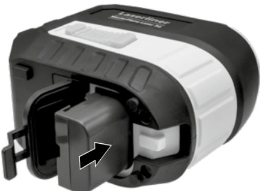
! Para o transporte, desligue sempre todos os lasers, trave o pêndulo e deslize o interruptor de corrediça (2) para a esquerda.
