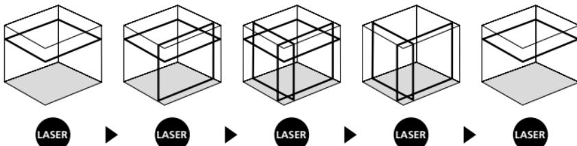
! Do niwelacji poziomej i pionowej zabezpieczenie transportowe musi być zwolnione. Gdy urządzenie znajduje się poza automatycznym zakresem niwelacji wynoszącym  $3,5^\circ$ , linie laserowe migają. Ustawić urządzenie tak, aby znalazło się w zakresie niwelacji. Linie laserowe znów świecą stale.
