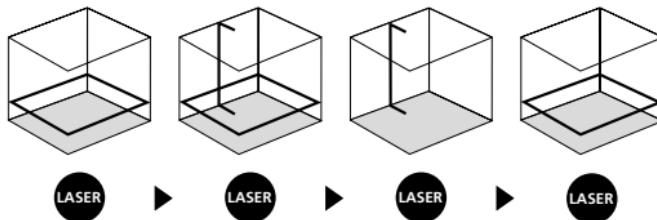
! Pro horizontální a vertikální nivelaci musí být uvolněna transportní pojistka. Jakmile se přístroj nachází mimo rozsah automatické nivelace  $3,5^\circ$ , blikají laserové linie. Umístěte přístroj tak, aby se nacházel uvnitř rozsahu nivelace. Laserové čáry se opět neustále rozsvěcují.
