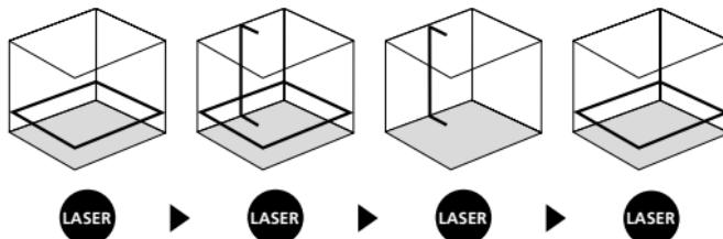
! Transportni zatvarač se mora otpustiti za horizontalno i vertikalno niveliiranje. Laserske linije bljeskaju čim je uređaj izvan raspona automatskog niveliiranja od 3,5°. Postaviti uređaj da bude unutar raspona nivelijacije. Laserske linije opet neprestano svijetle.
