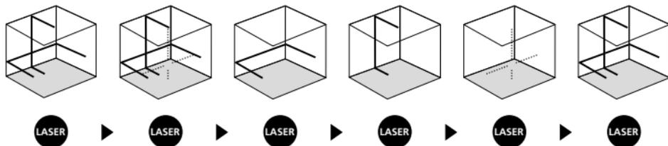
**!** Vaaka- ja pystysuuntaan tasaamista varten tulee kuljetusvarmistuksen olla vapautettuna. Kun laite on automaattisen tasausalueen 3,5° ulkopuolella, laserviivat vilkkuvat. Sijoita laite tasaiselle alustalle niin, että laite on tasausalueella. Laserviivat palavat jatkuvasti.
