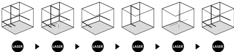
**!** Для горизонтального и вертикального нивелирования необходимо снять с блокировки фиксатор для транспортировки. Как только прибор окажется за пределами автоматического диапазона нивелирования, равного 3,5°, лазерные линии мигают. Позиционировать прибор так, чтобы он находился в пределах диапазона нивелирования. Лазерные линии снова светятся постоянно.
