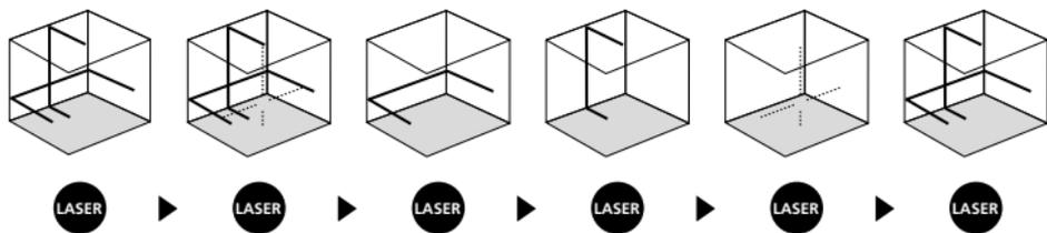
**!** Para a nivelção horizontal e vertical é preciso que o bloqueador de transporte esteja solto. Logo que o aparelho se encontrar fora da área de nivelção automática de 3,5°, as linhas de laser piscam. Posicione o aparelho de modo a que se encontre dentro da área de nivelção. De laser acendem novo constantemente.
