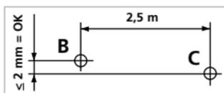
! Tarkista kalibrointi säännöllisesti ennen käyttöä ja kuljetuksen sekä pitkän säilytyksen jälkeen.
