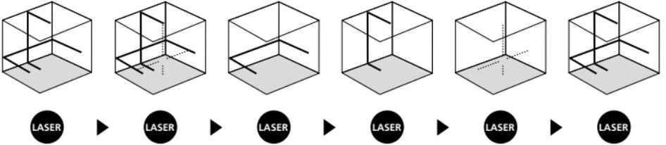
**!** Yatay ve düşey düzeçleme için taşıma emniyetinin çözülmüş olması gerekmektedir. Cihaz otomatik düzeçleme aralığı olan 3,5°'nin dışında bulunduğu zaman, lazer çizgileri yanıp sönmeye başlarlar. Cihazı düzeçleme aralığı içinde bulunacak şekilde konumlandırınız. Lazer çizgileri tekrar sürekli parlıyor
