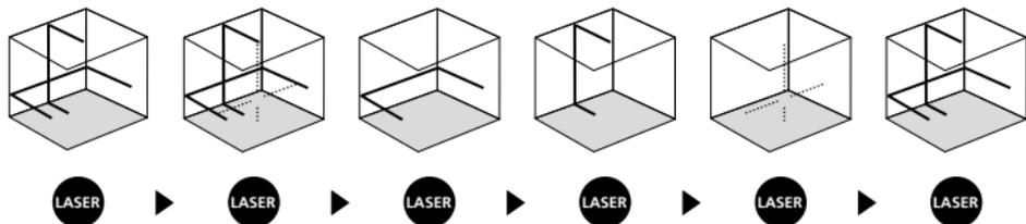
**!** Horisontal og vertikal nivellering krever at transportsikringen løsnes. Straks apparatet befinner seg utenfor det automatiske nivelleringsområdet på 3,5°, blinker laserlinjene. Posisjoner apparatet slik at det befinner seg innenfor nivelleringsområdet. Laserlinjene lyser konstant igjen.
