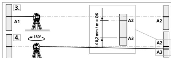
! Jos A2 ja A3 ovat toisistaan etäimmällä kuin 0,2 mm / m, on säätö tarpeen. Ota yhteys paikalliseen laitetoimittajaan tai UMAREX-LASERLINER huolto-osastoon.
