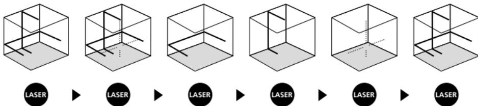
**!** Vid horisontell och vertikal nivellering måste transportsäkringeringen lossas. Så fort enheten befinner sig utanför det automatiska nivelleringsområdet på 3,5°, blinkar laserlinjerna. Positionera enheten på ett sådant sätt, att den befinner sig inom nivelleringsområdet. Laserlinjerna lyser konstant igen.
