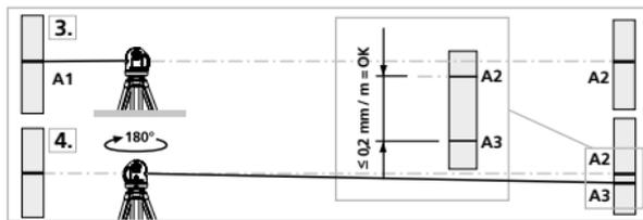
! Om A2 och A3 ligger mer än 0,2 mm / m från varandra behöver enheten justeras. Kontakta er återförsäljare eller vänd er till serviceavdelningen på UMAREX-LASERLINER.
