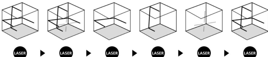
! Das Gerät lässt sich in jeder Laserauswahl durch gedrückt halten der Taste (7) ausschalten.
