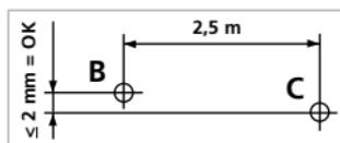
! Verificați periodic calibrarea înainte de utilizare, după transportare sau depozitare îndelungată.
