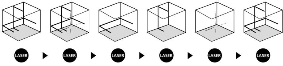
! Pentru nivelarea orizontală și verticală, siguranța pentru transport trebuie să fie îndepărtată. De îndată ce aparatul se află în afara domeniului de nivelare automată de  $3,5^\circ$ , razele laser pâlpâie. Poziționați aparatul astfel încât acesta să se afle în cadrul domeniului de nivelare. Liniile laser se aprind din nou în mod constant.
