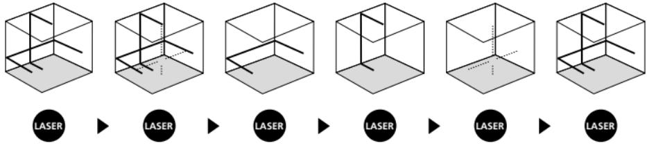
! Transportni zatvarač se mora otpustiti za horizontalno i vertikalno niveliiranje. Laserske linije bljeskaju čim je uređaj izvan raspona automatskog niveliiranja od  $3,5^{\circ}$ . Postaviti uređaj da bude unutar raspona nivelijacije. Laserske linije opet neprestano svijetle.
