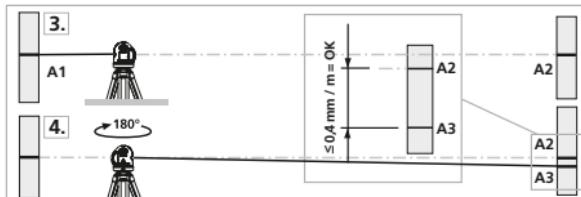
! Hvis A2 og A3 ligger mere end  $0,35 \text{ mm} / \text{m}$  fra hinanden, skal der foretages en justering. Indlever laseren til forhandleren, som sørger for det videre fornødne, eller kontakt serviceafdelingen hos UMAREX-LASERLINER.
