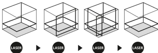
**!** За хоризонтално и вертикално нивелиране трябва да се освободи транспортното обезопасяване. Щом уредът се намира извън зоната на автоматично нивелиране  $3^\circ$ , лазерните линии мигат и LED светва в червено. Позиционирайте уреда така, че да се намира вътре в зоната на нивелиране. LED отново превключва на зелено и лазерните линии светят постоянно.
