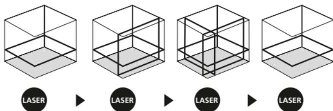
**!** Pentru nivelarea orizontală și verticală, siguranța pentru transport trebuie să fie îndepărtată. De îndată ce aparatul se află în afara domeniului de nivelare automată de 3°, razele laser pâlpâie iar LED-ul luminează roșu. Poziționați aparatul astfel încât acesta să se afle în cadrul domeniului de nivelare. LED-ul e aprinde din nou verde iar razele laser luminează constant.
