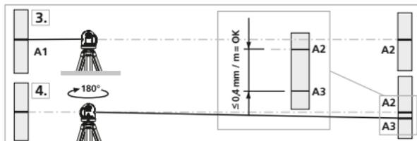
**!** Če sta A2 in A3 več kot 0,35 mm / m narazen, je treba napravo umeriti. Stopite v stik s prodajalcem ali pa se obrnite na servisni oddelek podjetja UMAREX-LASERLINER.
