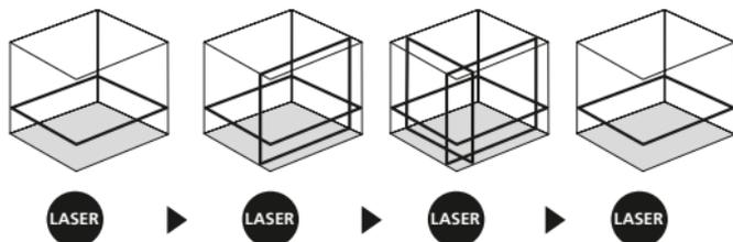
Horisontaalseks ja vertikaalseks nivelleerimiseks peab olema transpordikaitse vabastatud. Kui seade on väljaspool automaatset nivelleerimisvahemikku  $3^\circ$ , siis laserjooned vilguvad ja LED süttib punaselt. Positioneerige seade nii, et ta paikneks nivelleerimisvahemiku piires. LED lülitub taas roheliseks ja laserjooned põlevad konstantselt.
