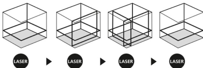
! Transportni zatvarač se mora otpustiti za horizontalno i vertikalno niveliranje. Laserske linije bljeskaju i upali se crveni LED čim je uređaj izvan raspona automatskog niveliranja od 3°. Postaviti uređaj da bude unutar raspona nivelacije. LED se ponovno prebaci na zeleno, a laserske linije prestanu bljeskati (svijetli postojanim svjetlom).
