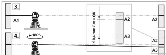
! Wanneer het verschil tussen punt A2 en A3 groter is dan de aangegeven tolerantie, nl. 0,4 mm / m, is een kalibratie nodig. Neem hiervoor contact op met uw vakhandelaar of met de serviceafdeling van UMAREX-LASERLINER.
