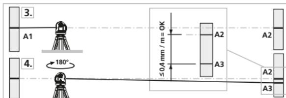
! Hvis A2 og A3 ligger mere end  $0,4 \text{ mm} / \text{m}$  fra hinanden, skal der foretages en justering. Indlevér laseren til forhandleren, som sørger for det videre fornødne, eller kontakt serviceafdelingen hos UMAREX-LASERLINER.
