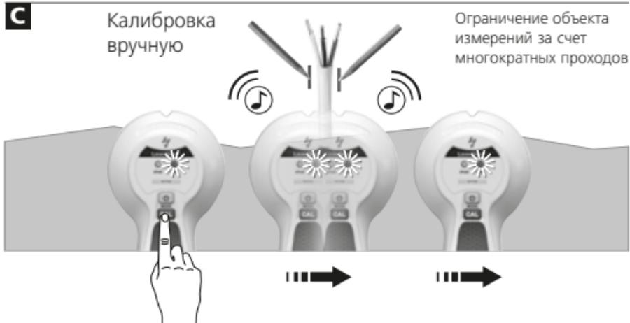
Указание 1: Ручная калибровка должна выполняться вблизи обнаруженного в последний раз места, см. рис. В/С. При необходимости повторить этот порядок действий.
