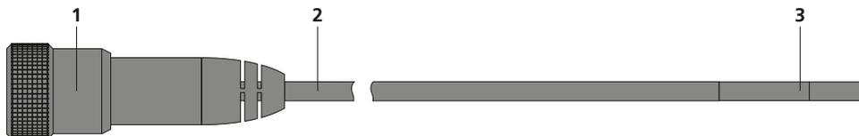
1 Место подсоединения базового блока
