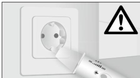
Pokud je úsek pod napětím, rozsvítí se hrot detektoru a zazní signál.
