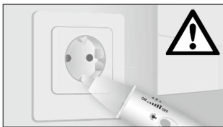
Priložte hrot detektora na meranú oblasť (napr. kábel, zásuvka atď.). Keď je napätie prítomné, svieti hrot detektora a zaznie signál.
